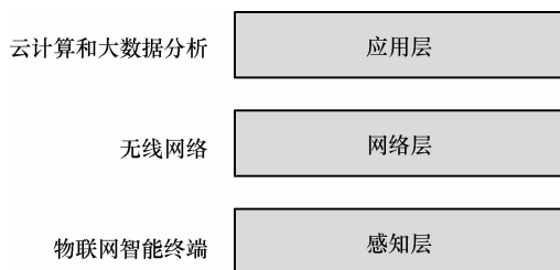
图 1 物联网 3 层架构
